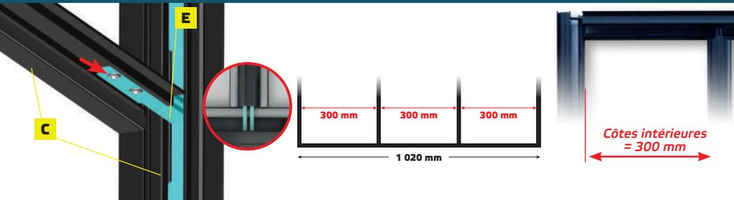
Réglez les Profils Traverses à 300 mm d'intervalle (bords à bords) et serrez les vis des équerres
