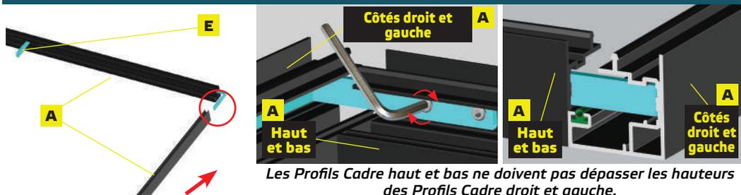
Les Profils Cadre haut et bas ne doivent pas dépasser les hauteurs des Profils Cadre droit et gauche.
