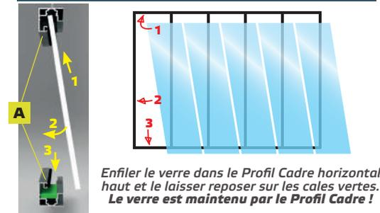
Enfiler le verre dans le Profil Cadre horizontal haut et le laisser reposer sur les cales vertes. Le verre est maintenu par le Profil Cadre !
