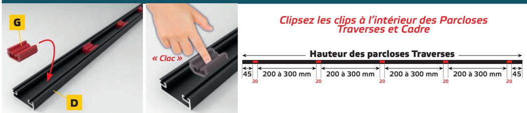
\* En cas de vitrage 44.2 ou phonique, les joints bulle ne sont pas nécessaires.
