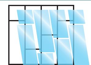
Enfiler le verre dans les Profils horizontaux, laissez reposer sur les cales. Le verre est maintenu !
