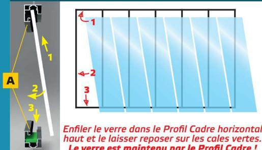
Enfiler le verre dans le Profil Cadre horizontal haut et le laisser reposer sur les cales vertes. Le verre est maintenu par le Profil Cadre !
