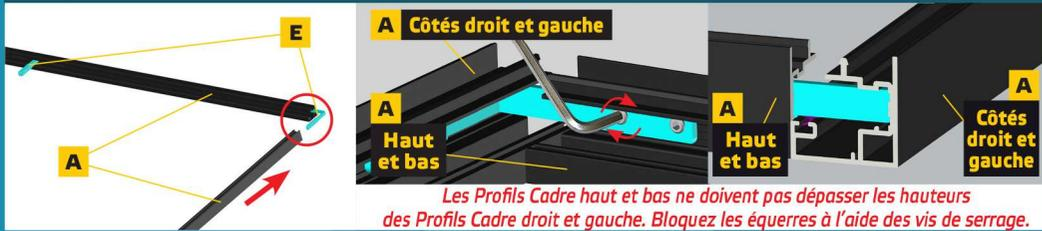
Les Profils Cadre haut et bas ne doivent pas dépasser les hauteurs des Profils Cadre droit et gauche. Bloquez les équerres à l'aide des vis de serrage.
