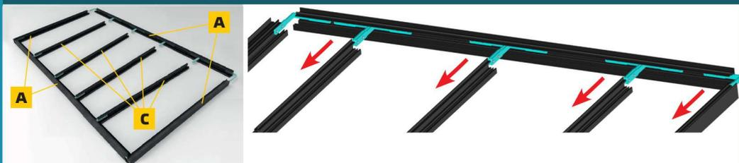
Assemblez le Cadre avec les Traverses. Bloquez les équerres à l'aide des vis de serrage.
