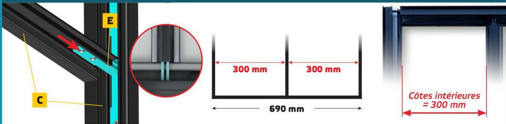
Réglez les Profils Traverses à 300 mm d'intervalle (bords à bords) et serrez les vis des équerres
