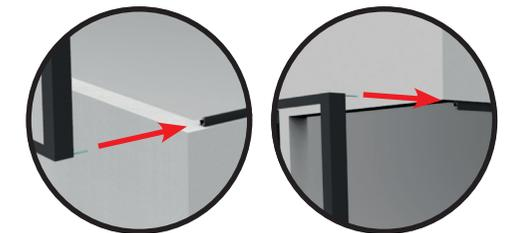
*La fixation de la verrière doit-être de niveau, d'équerre et rectiligne.*
