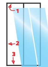
Enfiler le verre dans le Profil Cadre horizontal haut et le laisser reposer sur les cales vertes. Le verre est maintenu par le Profil Cadre !
