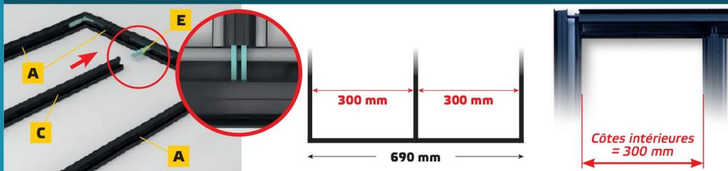
Réglez les Profils Traverses à 300 mm d'intervalle (bords à bords) et serrez les vis des équerres
