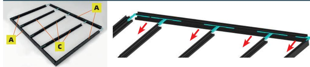
Assemblez le Cadre avec les Traverses. Bloquez les équerres à l'aide des vis de serrage.
