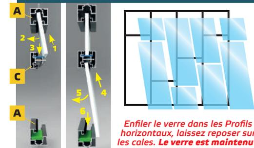
Enfiler le verre dans les Profils horizontaux, laissez reposer sur les cales. Le verre est maintenu !
