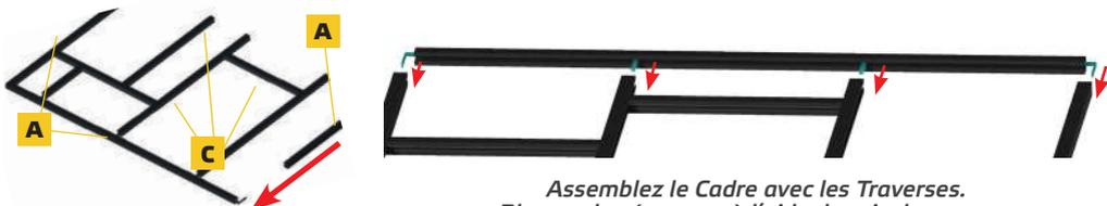
Assemblez le Cadre avec les Traverses. Bloquez les équerres à l'aide des vis de serrage.
