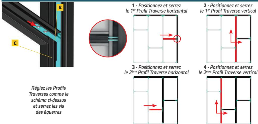
Réglez les Profils Traverses comme le schéma ci-dessus et serrez les vis des équerres
